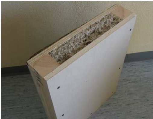
Bild 10: Photographische Aufnahme des Dämmelements (links) und Raumlufffeuchteauschläge im Testraum mit dem Dämmelement bezogen auf die Verhältnisse im Referenzraum (rechts).
